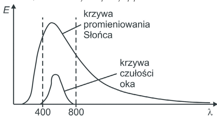
» Rys.2. Porównanie krzywej rozkładu energii promieniowania słonecznego z krzywą czułości oka
