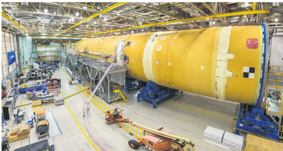
» Główny człon rakiety SLS w placówce NASA Michoud. Stopień jest już gotowy w 80%. Źródło: NASA/Eric Bordelon
